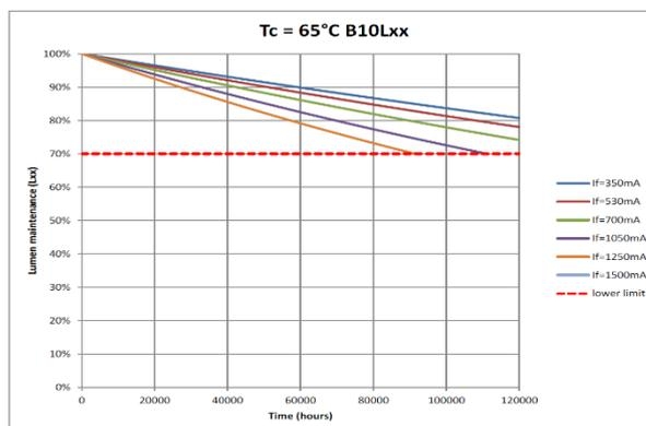
L88B10 pour un Tc à 65°C et un courant d'alimentation de 530mA à 60 000h.
