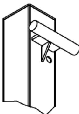
La lanterne vient se fixer sur l'axe soudé au mât grâce à des brides de serrage. Vous pouvez ainsi régler l'angle de la lanterne.
